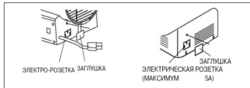
Рис.5. Дополнительная электрическая розетка.
